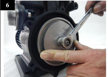
Tighten up the stud bolt.
